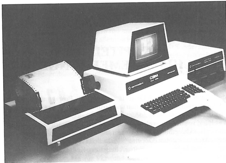
Bild 11-1: Der PET: Ein typischer Heimcomputer mit allen Bestandteilen in einem Gehäuse
